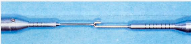
Figura 4. Dontrix tipo Richmond, uno de cuatro onzas y uno de dieciséis onzas se jalan uno contra otro. El dontrix de dieciséis (a la izquierda) registra cuatro onzas mientras que el dontrix de cuatro onzas (a la derecha) muestra la verdadera tracción de dos onzas.
