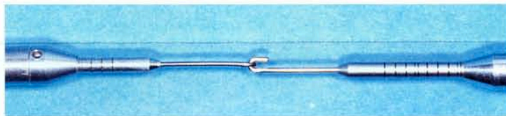
Figure 4. Une jauge de 4 onces et une autre de 16 onces tirant l'une sur l'autre. Sur la jauge de 16 onces (à gauche) on lit 4 onces, tandis que la jauge de 4 onces (à droite) enregistre la valeur réelle de 2 onces.
